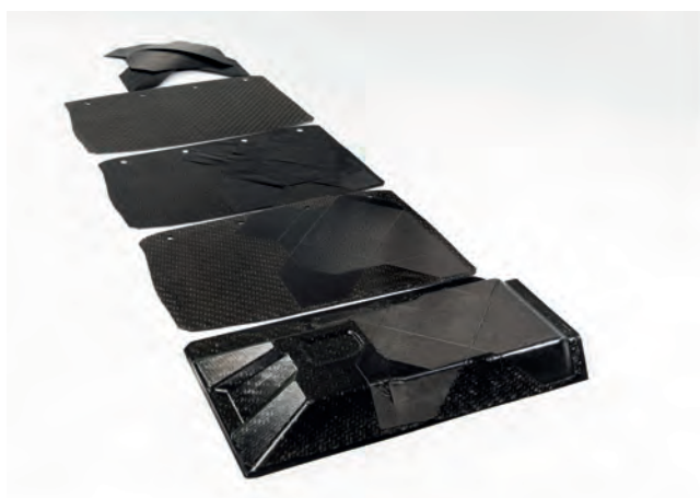
Bild 5. Die sehr gute Qualität der Musterteile und die hohe Effizienz des integrierten Verarbeitungsprozesses belegen das große Potenzial der Aufbereitung von Organoblechverschnittabfällen © Engel
