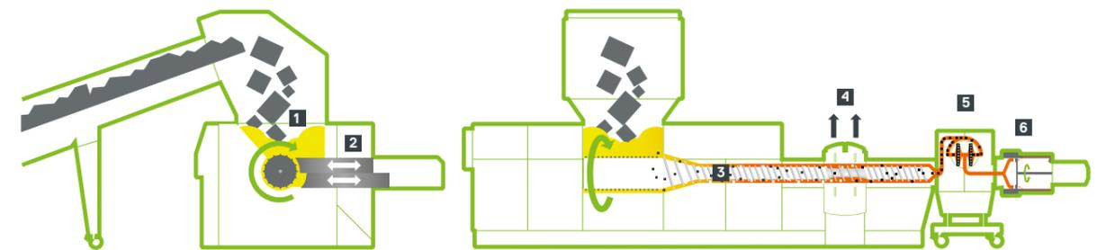
**1** Broyeur à arbre unique **2** Double système de trappe **3** Extrudeuse disposée coaxialement **4** Zone de dégazage **5** Filtre entièrement automatique et autonettoyant **6** Système de granulation
